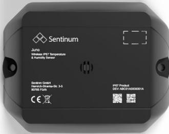
Der Juno IP67 TH ist ein vielseitiger Temperatur und rel. Luftfeuchtigkeitssensor, der mioty®, LoRaWAN® oder cellular Technologien wie z.B. NB-IoT und LTE-CAT-M1 für eine zuverlässige und energieeffiziente Datenübertragung nutzt. Durch seine robuste Bauweise und das IP67 Rating ist er optimal für den Einsatz in anspruchsvollen Umgebungen geeignet und widersteht Staub, Wasser und hohen Drücken.
